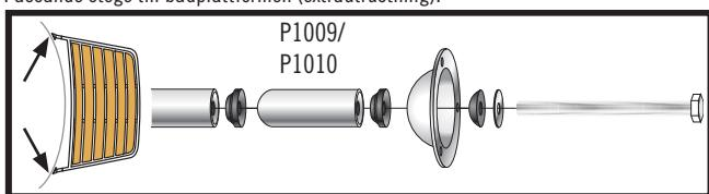
Förlängning + 50 mm finns att beställa. P1009 (Ø25 mm), P1010 (Ø32 mm).
