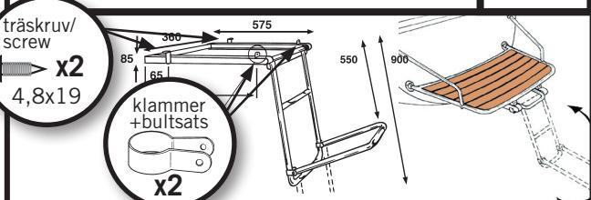
BK90 monteras med klammer om plattformens yttre rör och tråskruv i teken.
