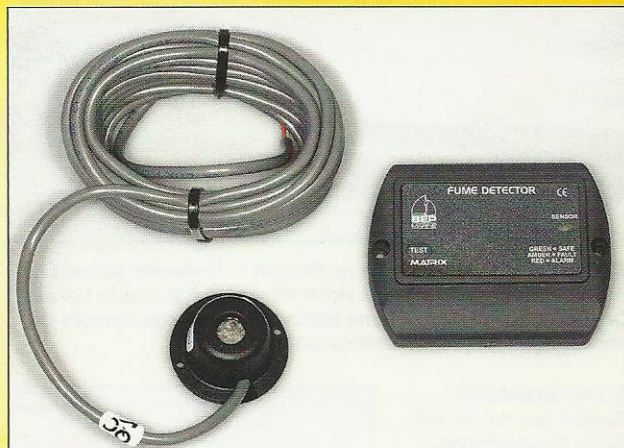
GASSALARM: BEP har et utmerket alarmsystem for gass. Selve alarmer plasseres i salongen, mens føleren monteres så lavt som mulig i båten.
