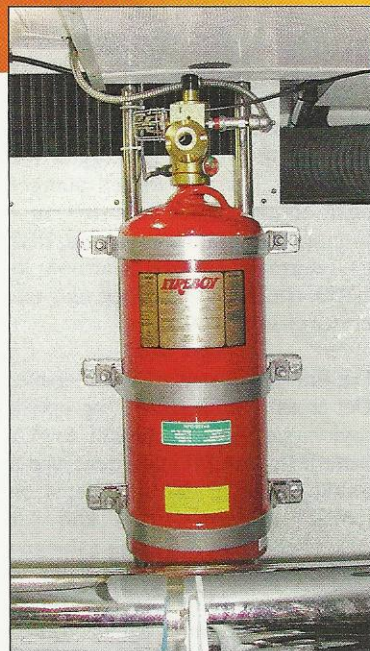
AUTOMATISK BRANNSLUKKINGS-ANLEGG: Det er krav til automatisk brannslukkingsanlegg i nye båter med mer enn 163 hk motor. Illustrasjonsfoto som ikke stemmer helt med det som selges. Foto: Fireboy.
